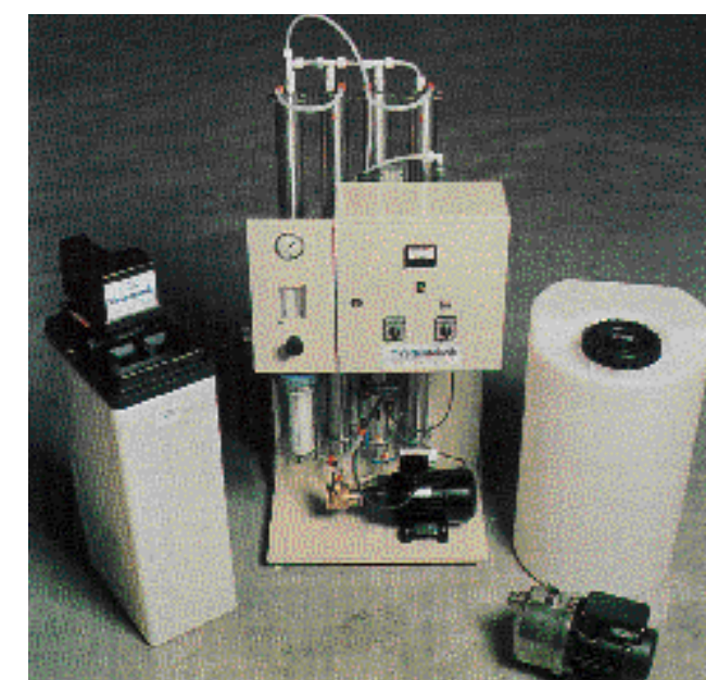
Komplett anläggning med RO-4.2F (kap. 152 liter/timme vid 10 grader råvattentemperatur), avhärtningsfilter som förbehandling, förrådstank och distributionspump.
